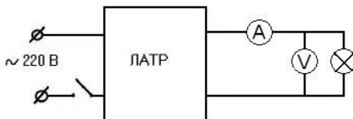
Рис. 3. Схема цепи исследуемой лампы
