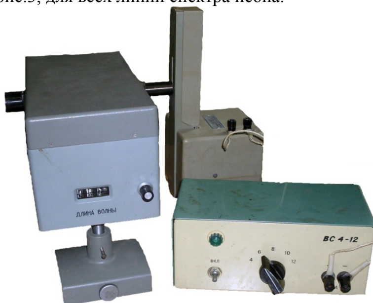
Рис. 3. Вид установки для измерения постоянной Ридберга
